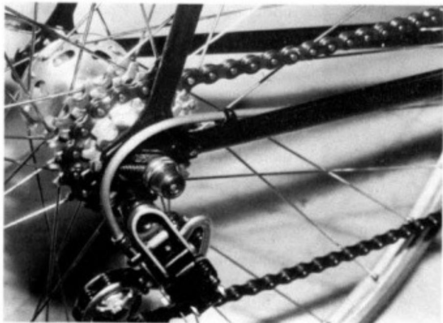
Le câble de dérailleur arrière est dissimulé tout au long de la base
