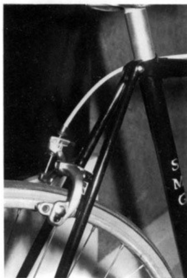
Tube de selle raccordé avec les haubans à double coniflage.
